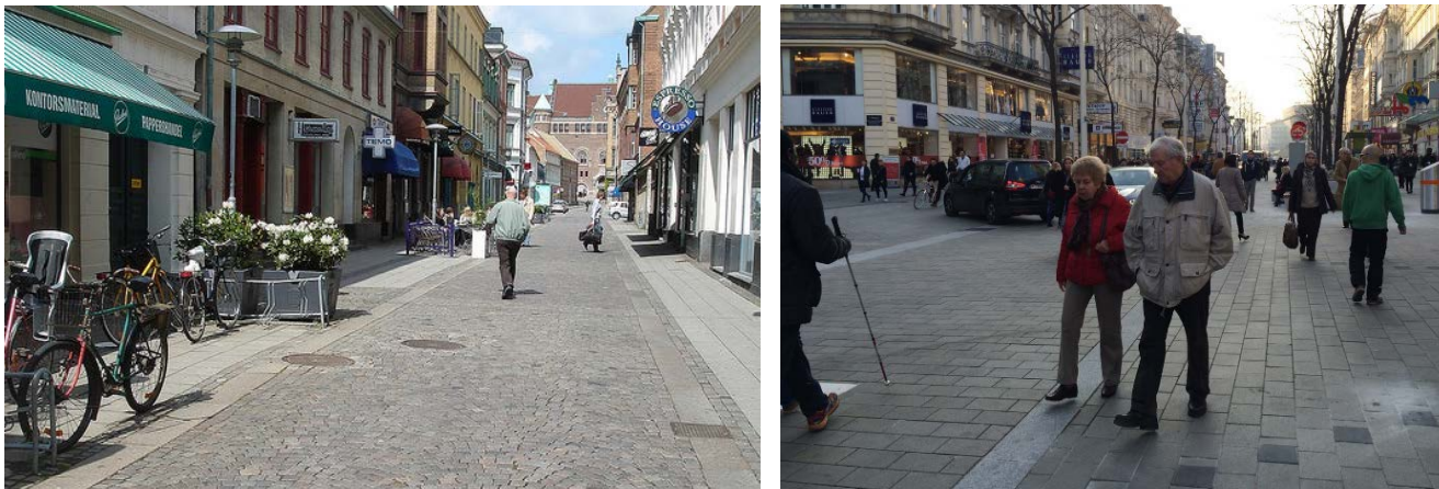
Figura 145: Libertate și confort de mișcare pentru pietoni, în întreg spațiu urban, fără bariere fizice și psihologice (fără diferențe de nivel și diferențe majore de textură: trotuar-carosabil)
