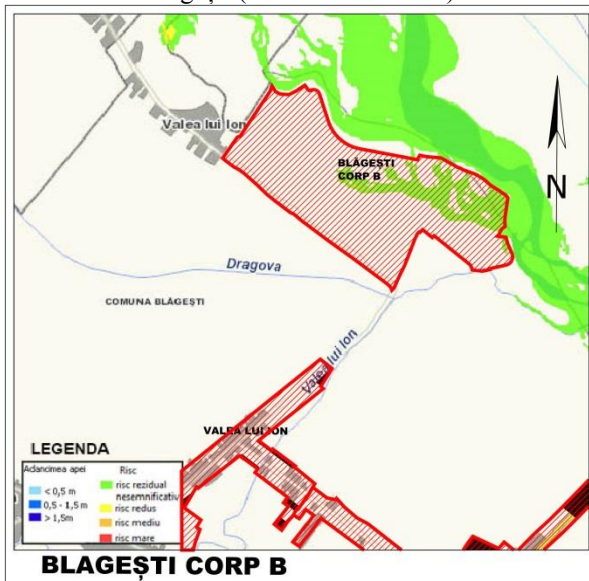
Risc de inundații cu probabilitate de depășire de 10% la Blăgești (adică la 10 de ani)
