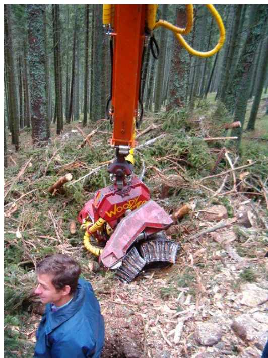
Fig. 5. Combină de fasonare a materialului lemnos recoltat
