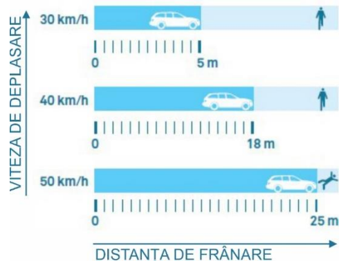
Figură 7-3 Relația dintre viteză și distanța de frânare;
