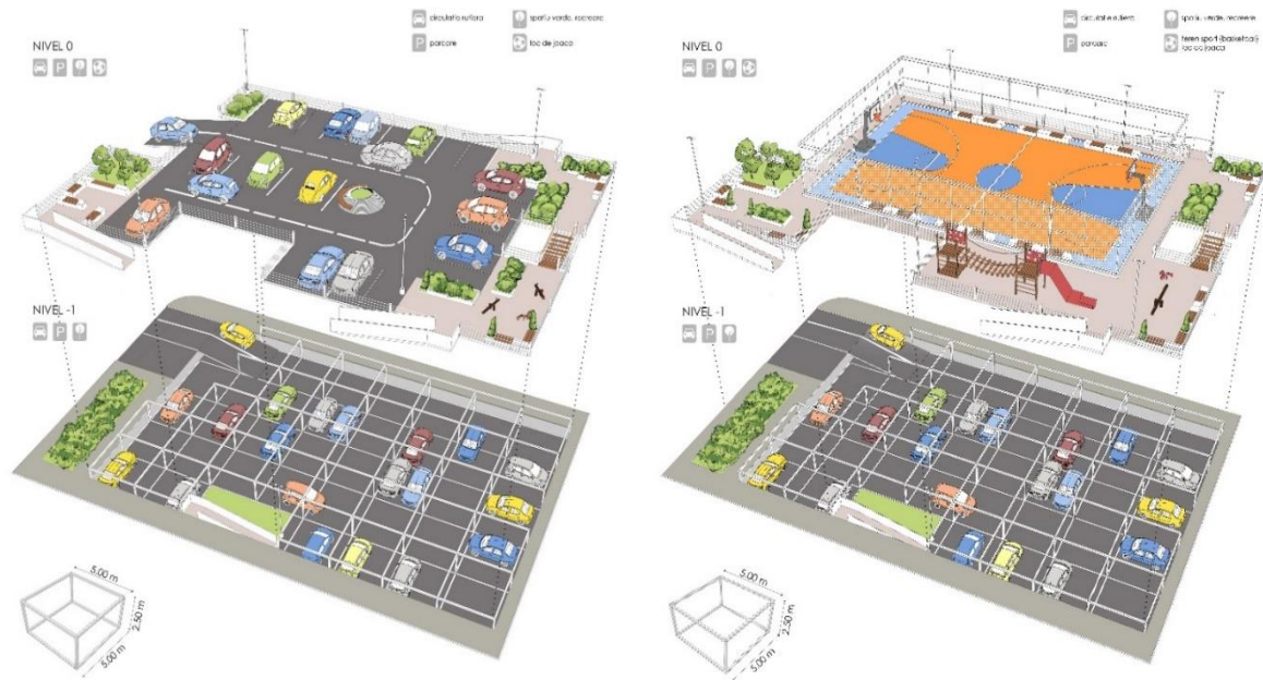
Figură 6-16 - Axonometrii – varianta orientată către parcare; varianta orientate către amenajare loc de joaca (teren de sport)
