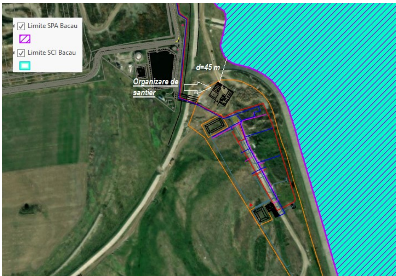
Figura 72 Distanța de la organizarea de șantier până la limitele ariilor naturale protejate ROSPA0063 Lacurile de acumulare Buhuși - Bacău – Berești și ROSCI0434 Siretul Mijlociu
