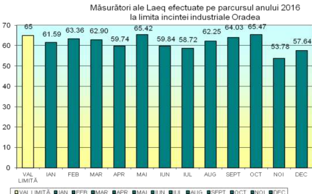
Figura nr. VIII.1.2.1.5 Măsurători ale Laeq – limită incintă industrială
