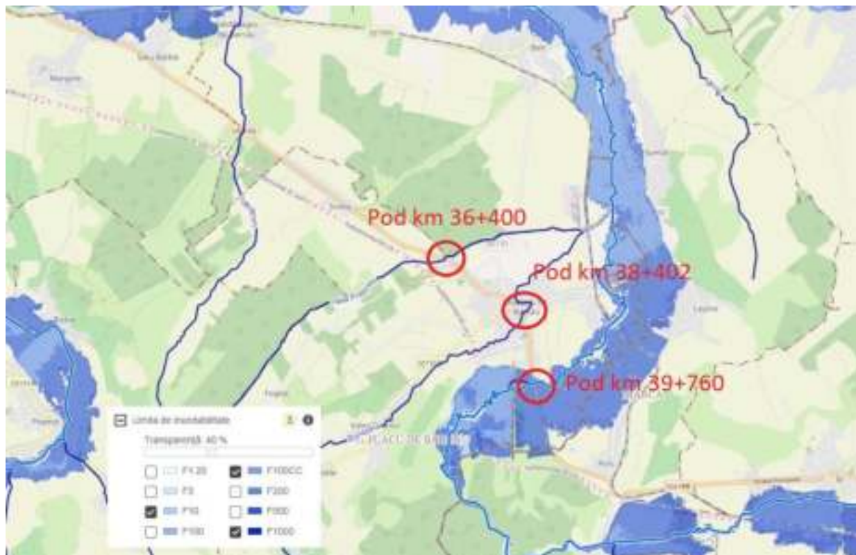
Figura 19 Harta detaliată de hazard și risc la inundații a zonei de implementare a proiectului – sursa: inundații.ro
