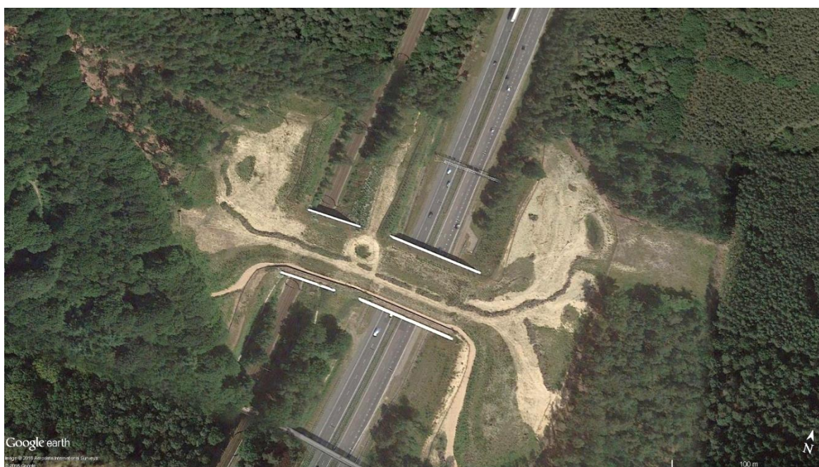
Figura nr. 8-6 Pasaj pentru faună ce supratraversează o autostradă și o cale ferată, Olanda, sursa: Google Earth Pro
