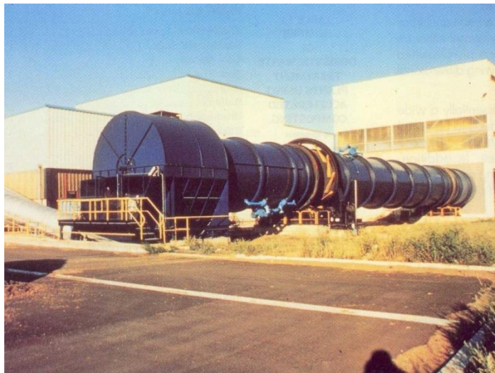
Figura 7-15 Instalație de compostare dinamică cu tambur de alterare
