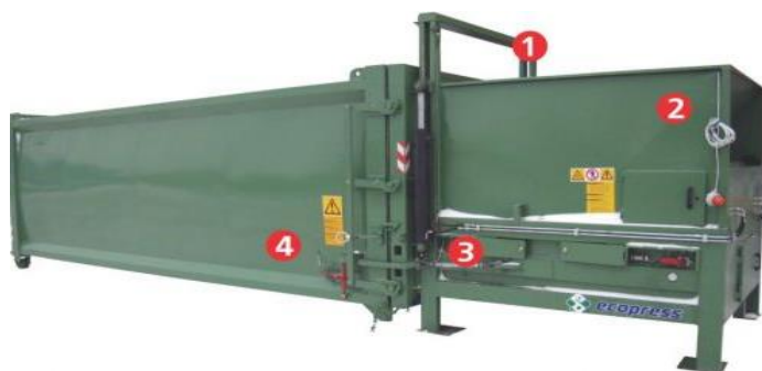
Figura 7-8 Sistem de compactare fix al deșeurilor
