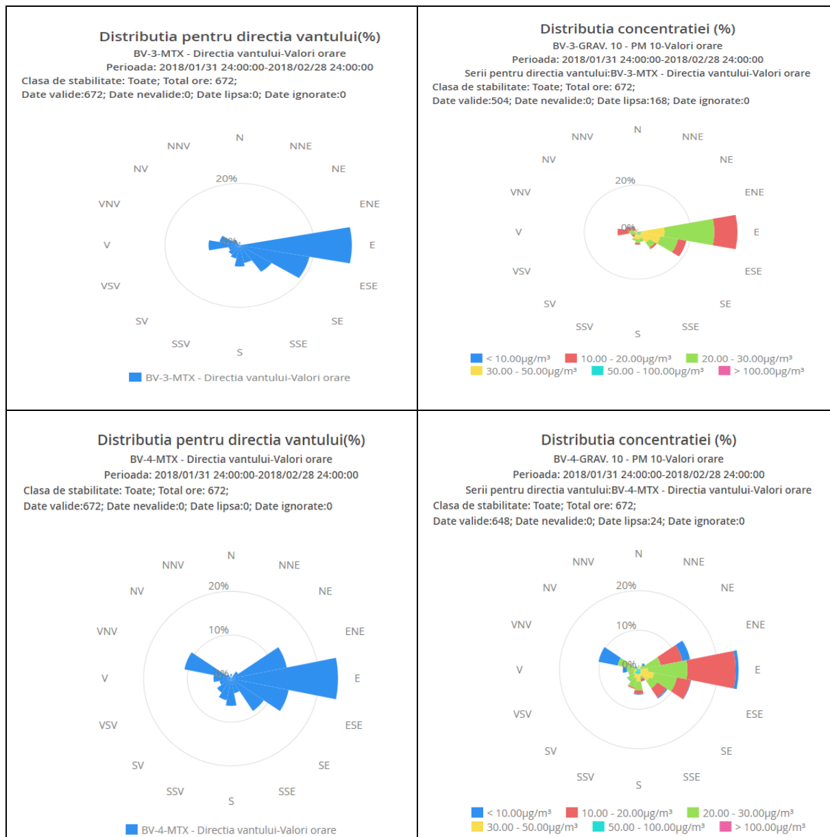
Figura 1.1.2.9.6. Grafic vânt și vânt – concentrație de PM10 la stația BV2, BV3 și BV4 în luna februarie 2018
