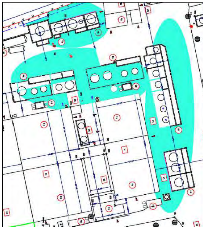
Figura 22 - Amplasarea rezervoarelor principale de materii prime
