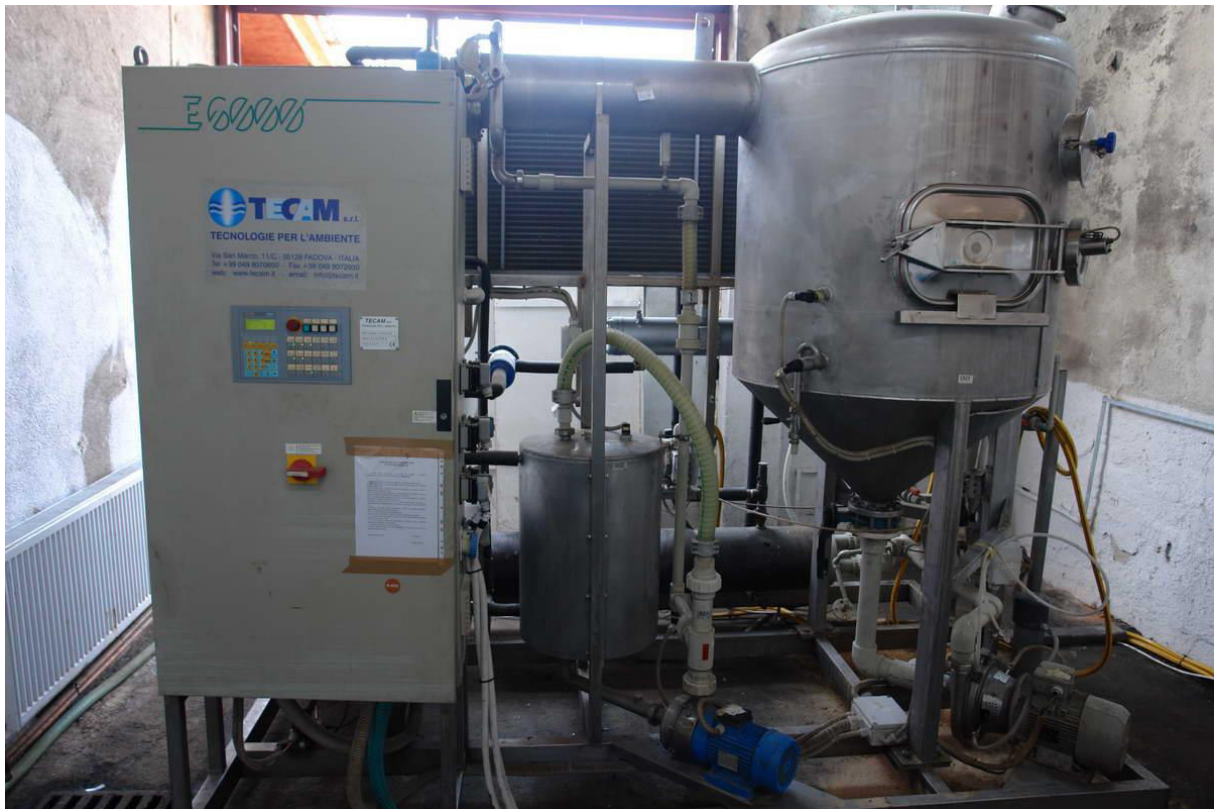
Fig. 2.3.2-9 Instalația de distilare E6000
