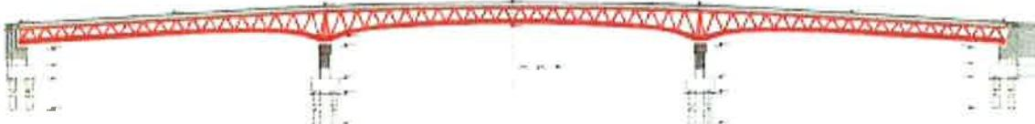
Schema statica a structurii este grinda continua cu 3 deschideri de 65.00-80.00-65.00 m, rezultand o lungime totala a suprastructurii de 211.00 m. Lungimea totala a pasajului este de 216.00 m.
