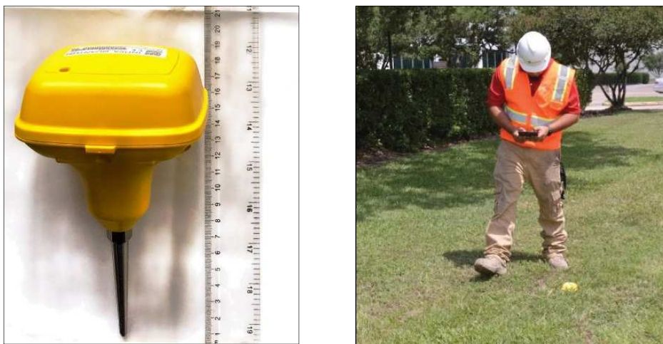
Fig. 17 Amplasarea geofonilor pe teren (sursa foto: Prospectiuni SA)
