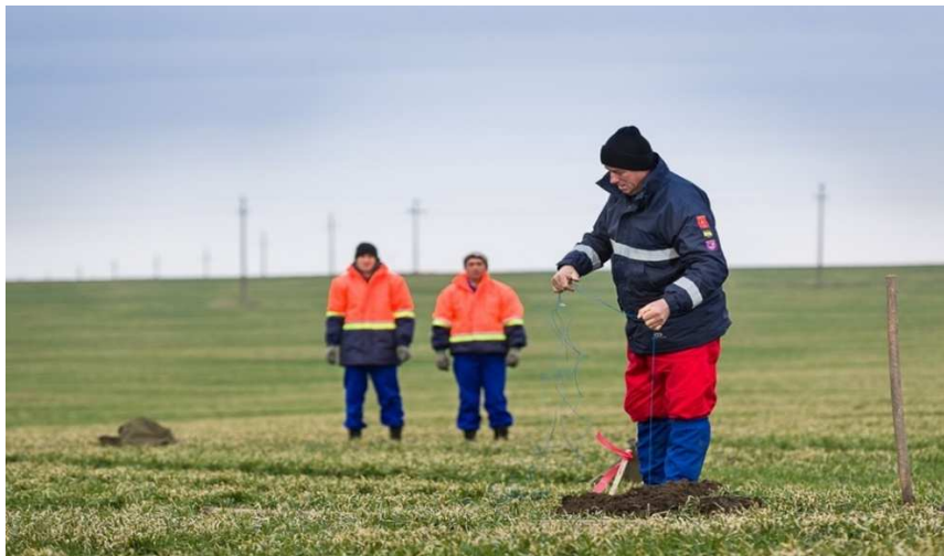
Fig. 11 Incarcarea gaurii pentru detonare controlata (sursa foto: Prospectiuni SA)
