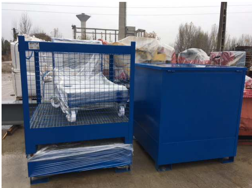
3. Container colectare si depozitare deseuri (lubrifiantilor si a substantelor de mentenanta);
