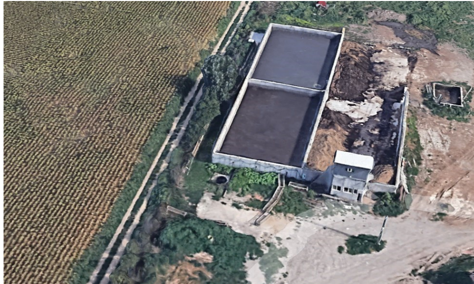
Fig.26 – Sistem depozitare dejectii si ape uzate tehnologice
