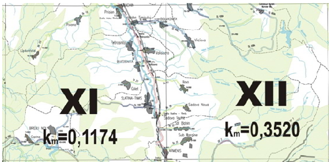
Figura nr. 33. Amplasarea comunei Slatina – Timiș față de potențialele zonei ale declanșării alunecărilor de teren
