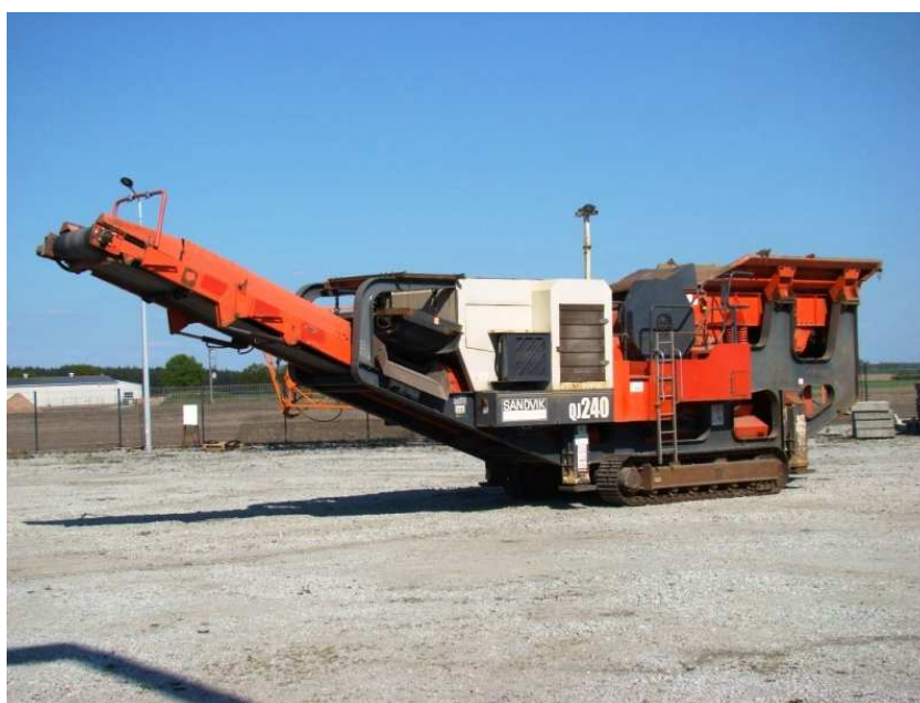
Img. 3 Concasor mobil
