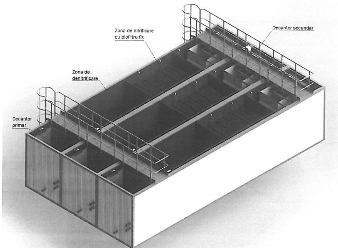
Din bașa decantorului secundar, nămolul sedimentat este evacuat cu ajutorul pompelor.
