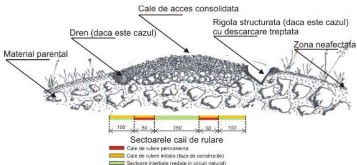
Fig.7 Structura transversală a drumurilor propuse (lățime 4, la racorduri în curbă <math>< 7m</math>)*
