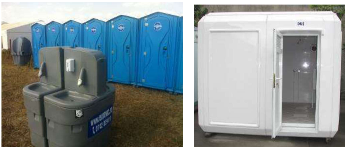
Fig. 6 Model de soluție de asigurare a condițiilor de igienă pe amplasamente temporare cu un număr mare de lucrători: toalete ecologice, cu bazin etanș, vidanjabil, tratat chimic; lavoare de spălare cu rezervoare etanșe ce asigură apa de spălare ce este apoi re-introdusă în rezervor distinct, etanș, vidanjabil
