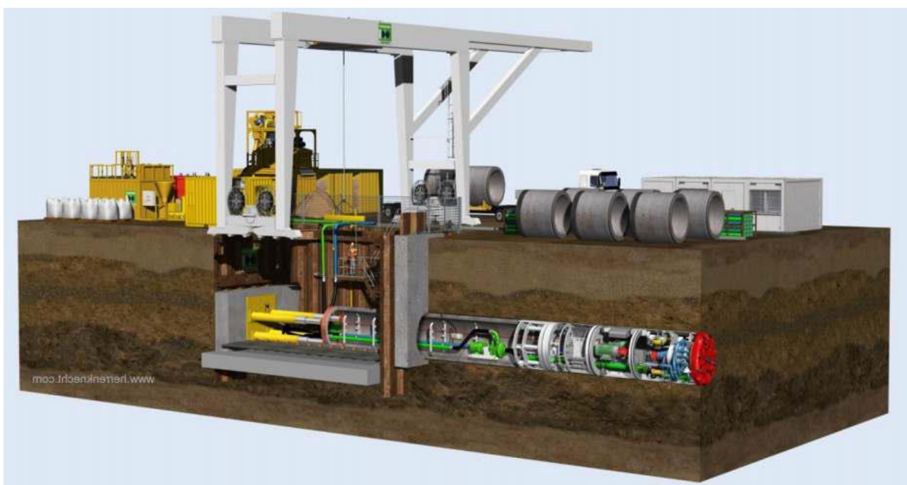
Figura 10.2 Prezentarea procesului tehnologic de execuție microtunel
