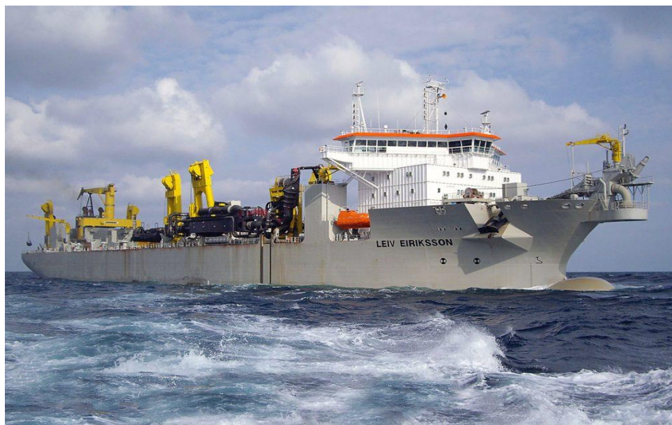
Fig. 2. Navă tip TSHD cu capacitate mare de dragare și stocare ( https://www.polandatsea.com/leiv-eiriksson-the-worlds-largest-dredger-in-the-gulf-of-gdansk/ )
