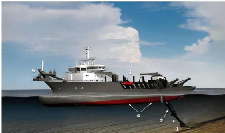
Fig. 7. Operațiunea de încărcare a unei nave tip TSHD ( http://www.technofysica.nl/Dutch/case4.htm )
