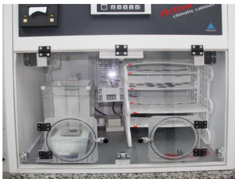
Figura 3.1.1 Cameră de condiționare filtre - Balanță Activa
