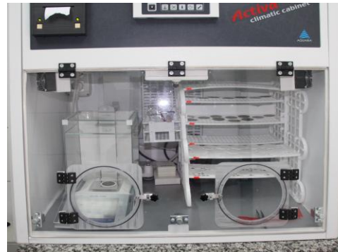
Figura 3.1.1 Cameră de condiționare filtre - Incinta Activa
