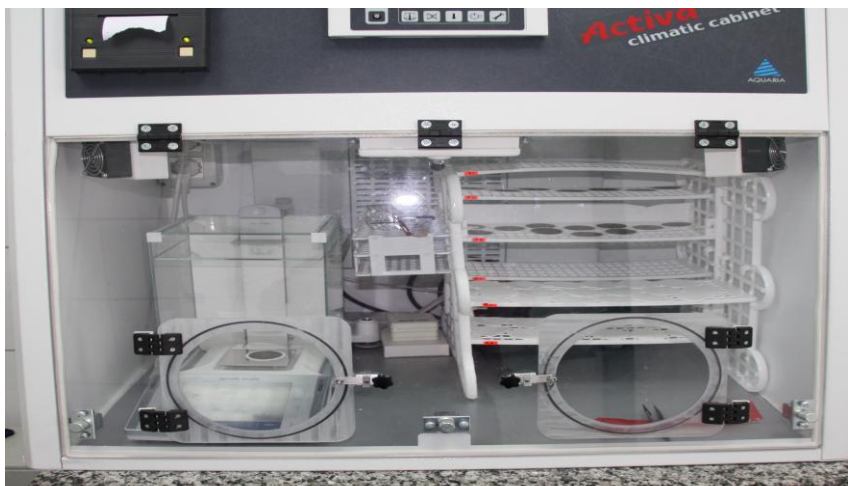
Figura 3.1.1 Cameră de condiționare filtre - Incinta Activa
