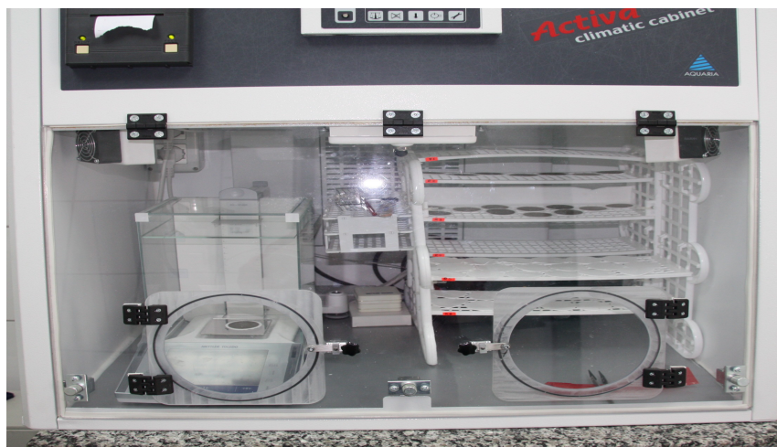
Figura 3.1.1 Cameră de condiționare filtre - Incinta Activa
