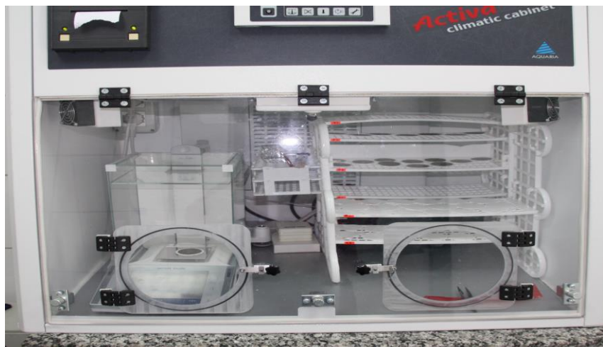
Figura 3.1.1 Cameră de condiționare filtre - Incinta Activa
