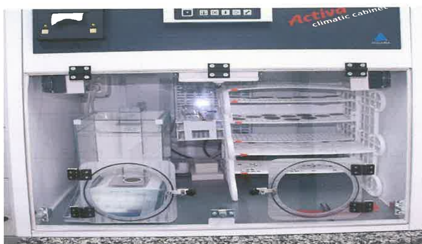
Figura 3.1.1 Cameră de condiționare filtre - Incinta Activa
