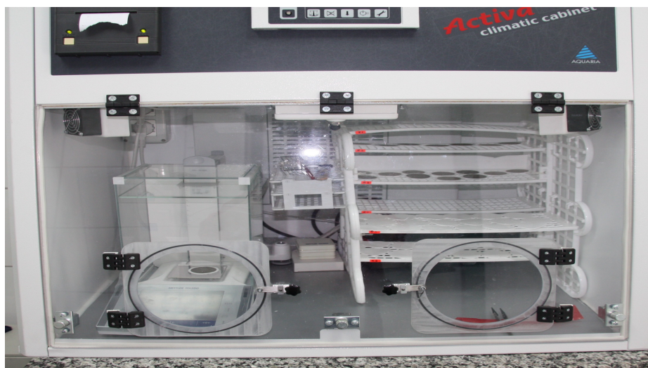
Figura 3.1.1 Cameră de condiționare filtre - Incinta Activa
