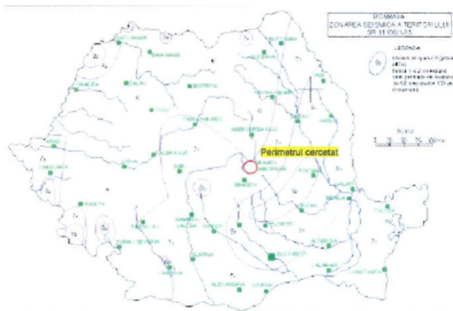
Figura 54 – Zonarea teritoriului Romaniei in termeni de intensitate seismica conform cod P100-1/2013 „Codde proiectare seismica”
