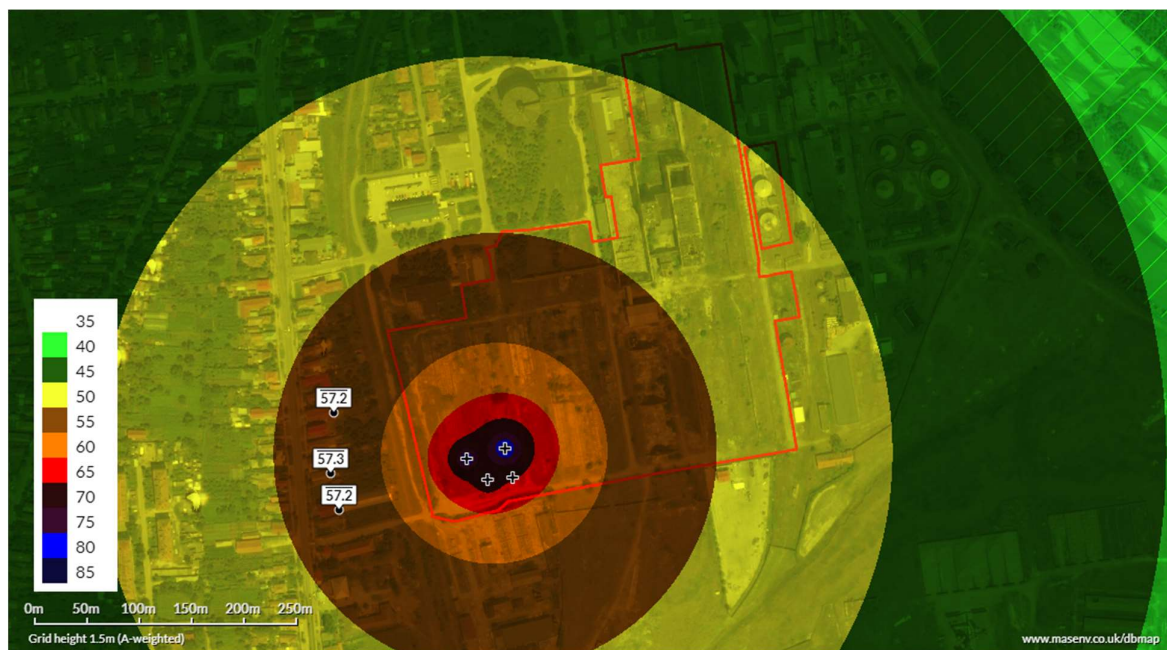
Figura 2 Nivelul echivalent de zgomot generat de sursele de zgomot aferente etapei de construcție (valorile reprezintă dB(A))
