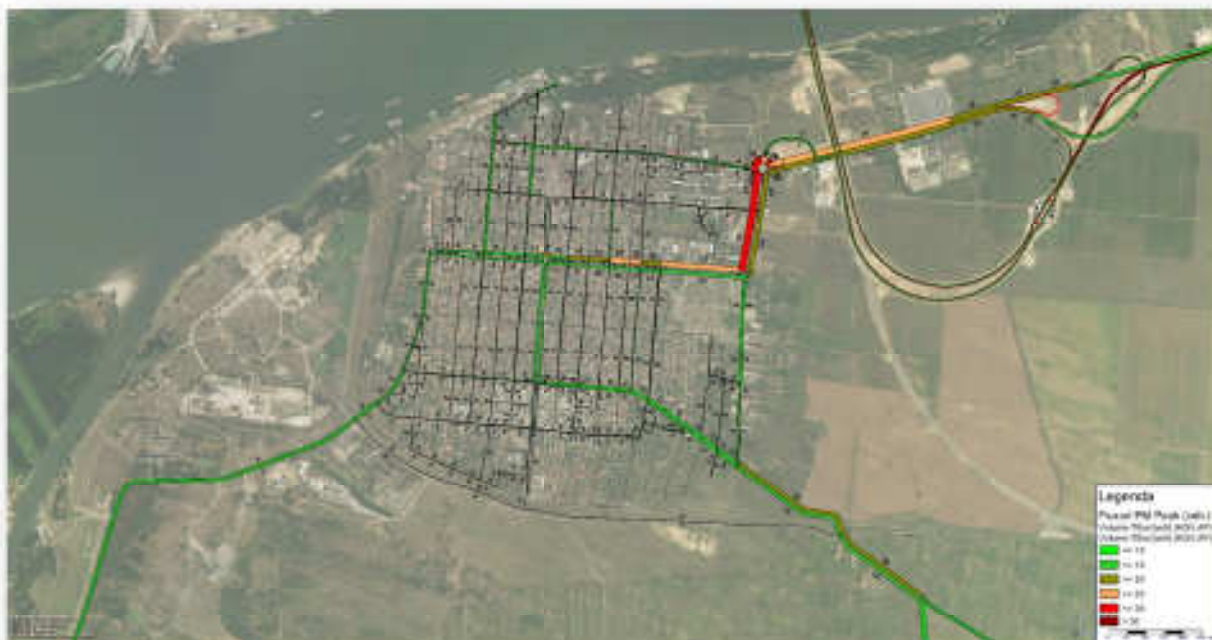
Figură 63-Fluxul de vehicule de mărfuri (trafic orar, ora de vârf PM)
