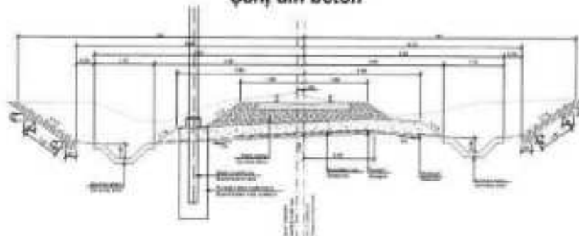
Șanț din beton
