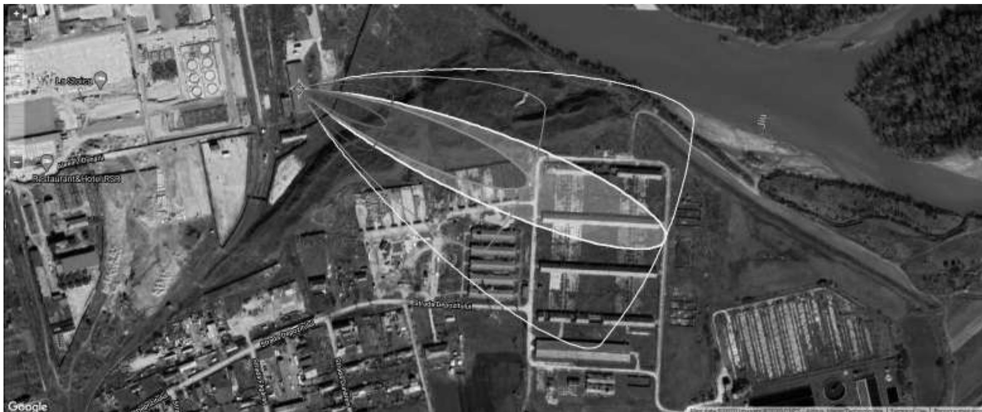
Figură 63: modelarea matematică a deplasării norului de SO 2 în raport cu distanța scenariul 9.2.2. – limitele 200, 30 și 12 ppm
