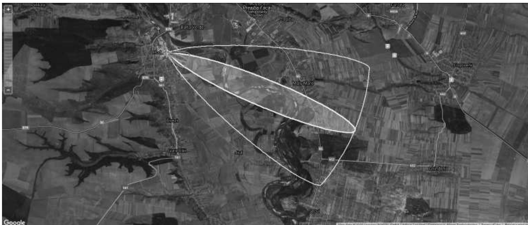
Figură 61: modelarea matematică a deplasării norului de SO 2 în raport cu distanța scenariul 9.2.1. – limitele 1200, 30 și 0,75 ppm
