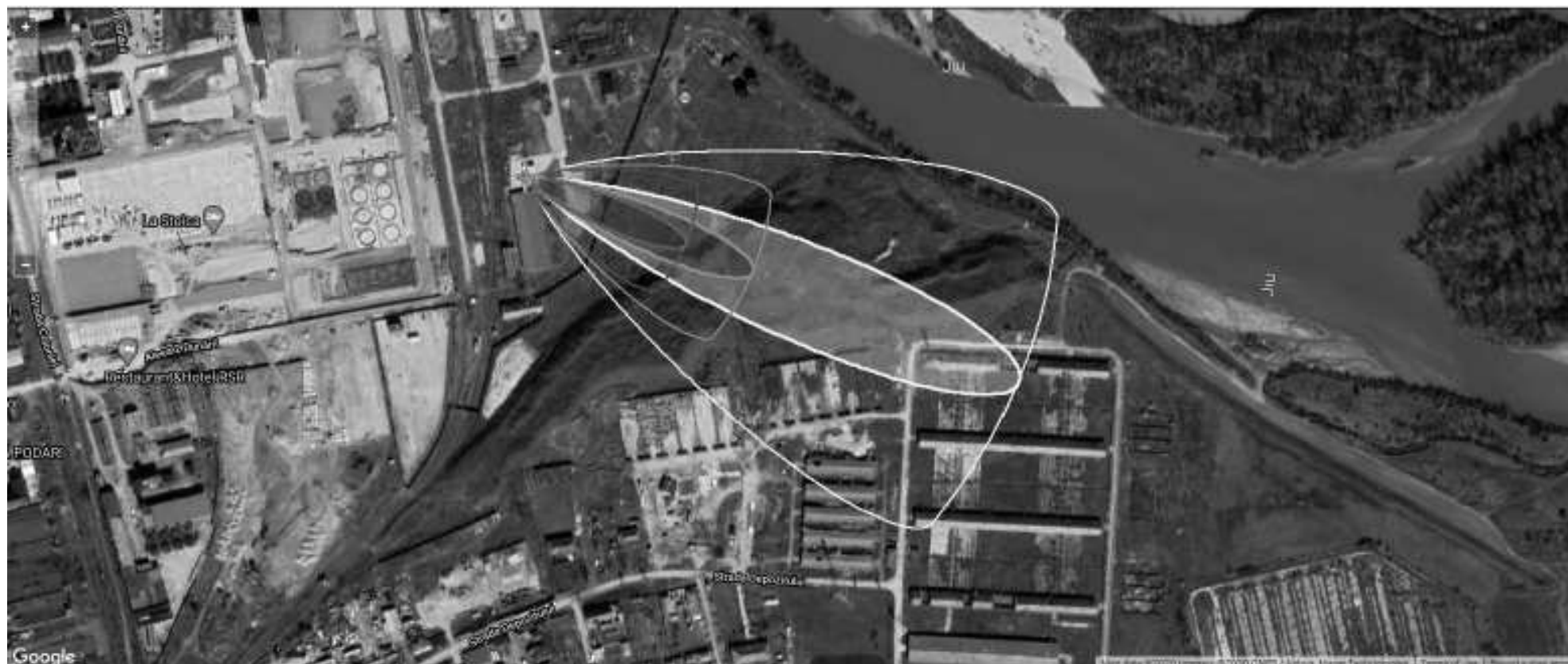
Figură 53: modelarea matematică a deplasării norului de HCl în raport cu distanța scenariul 7.2.4. – limitele 200, 100 și 22 ppm
