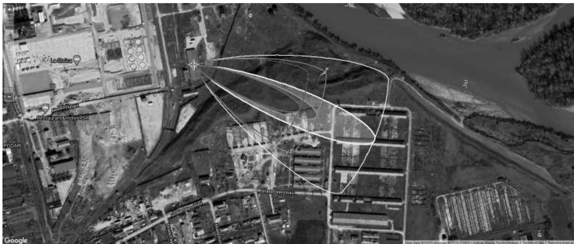
Figură 65: modelarea matematică a deplasării norului de HCN în raport cu distanța scenariul 9.2.3. – limitele 20, 15 și 7,1 ppm
