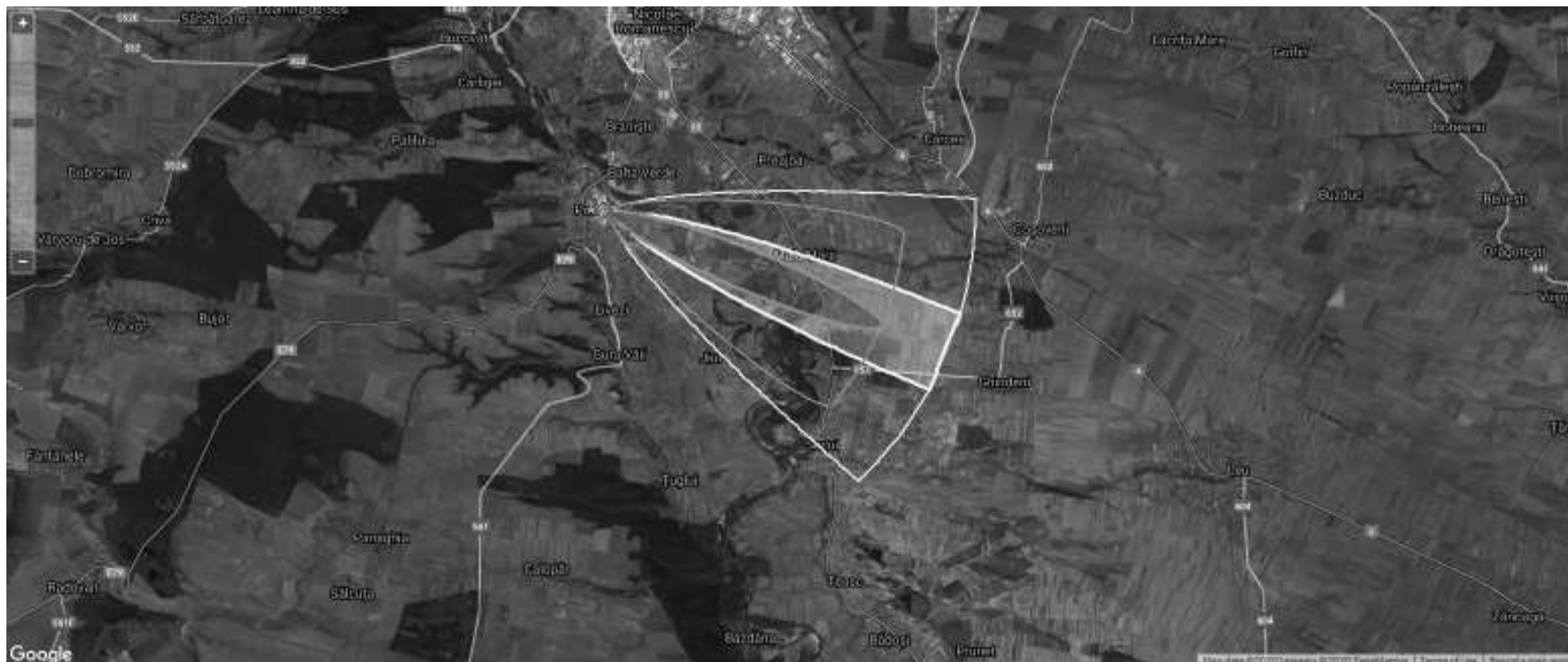
Figură 62: modelarea matematică a deplasării norului de SO 2 în raport cu distanța scenariul 9.2.1. – limitele 30, 0,75 și 0,2 ppm
