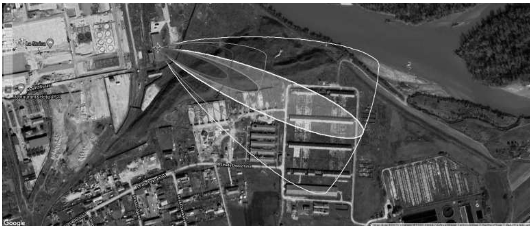
Figură 69: modelarea matematică a deplasării norului de CO în raport cu distanța scenariul 9.2.5. – limitele 680, 330 și 83 ppm
