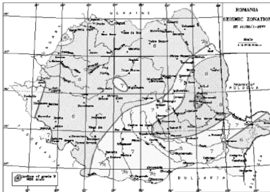
Figură 18: Zonarea seismică a teritoriului României pe baza intensităților pe scara MSK conform SR 11100-1:93 „Zonarea seismică. Macrozonarea teritoriului României”
