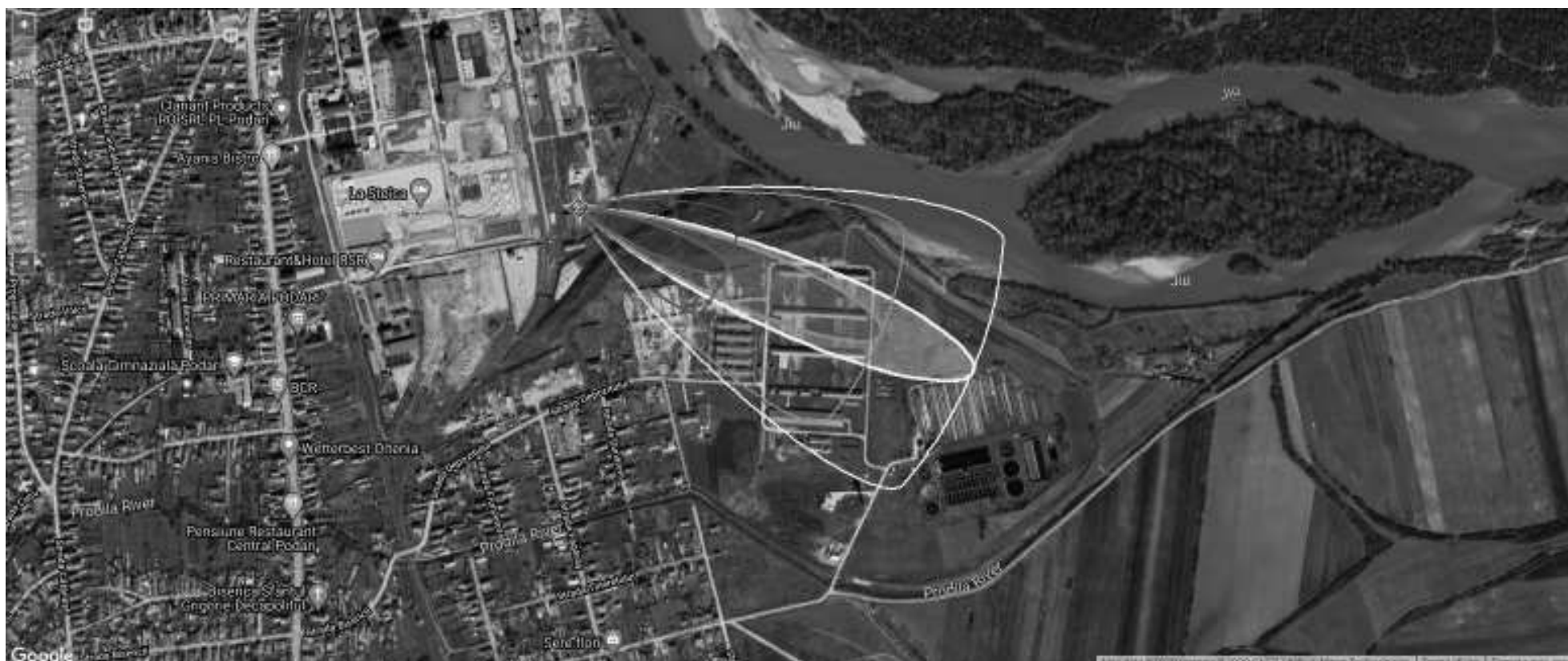
Figură 70: modelarea matematică a deplasării norului de CO în raport cu distanța scenariul 9.2.5. – limitele 330, 83 și 50 ppm
