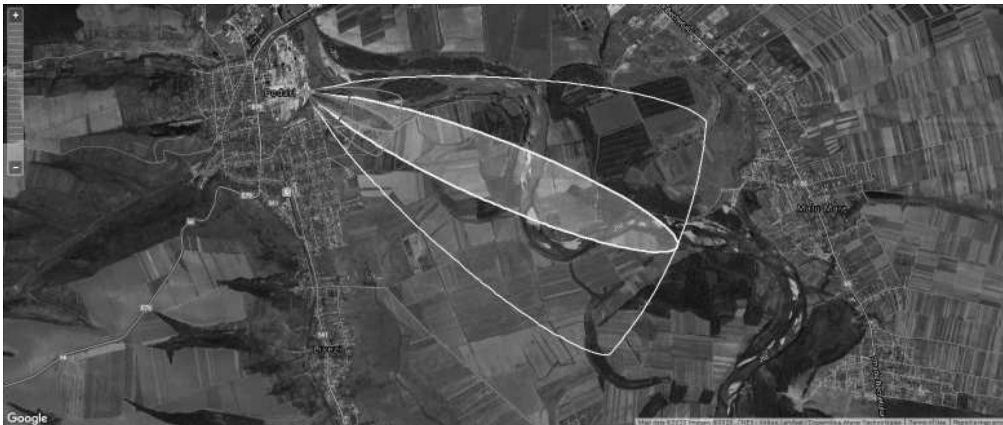
Figură 68: modelarea matematică a deplasării norului de HCl în raport cu distanța scenariul 9.2.4. – limitele 100, 22 și 1,8 ppm
