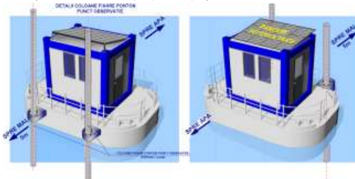
Punct de observație tip 1. Container pe platformă plutitoare.
