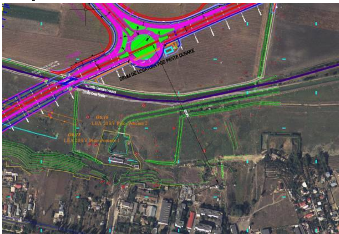
Figura 19. Amplasarea giratiei din zona de început a proiectului (km 1+524.61) în raport cu locuințele / zonele construite
