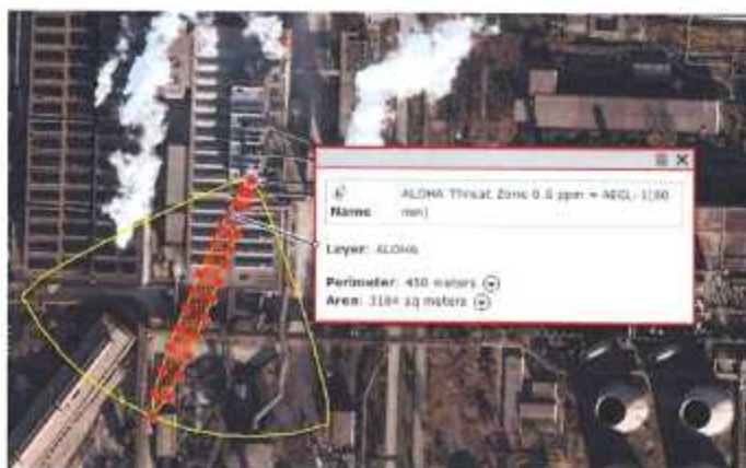
Zona de impact Convertizor nr. 3 – Dioxid de azot (NO 2 )
