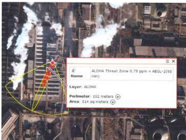
Zona de impact Convertizor nr. 2 – Dioxid de sulf ( \text{SO}_2 ) Portocaliu: 74 m; Perimetru: 152 m; Suprafața: 514 mp; Conc. 0,75 ppm = AEGL-2(60 min)
