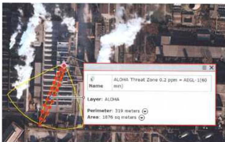
Zona de impact Convertizor nr. 2 – Dioxid de sulf ( \text{SO}_2 ) Galben: 157 m; Perimetru: 319 m; Suprafața: 1876 mp; Conc. 0,2 ppm = AEGL-1 (60 min)
