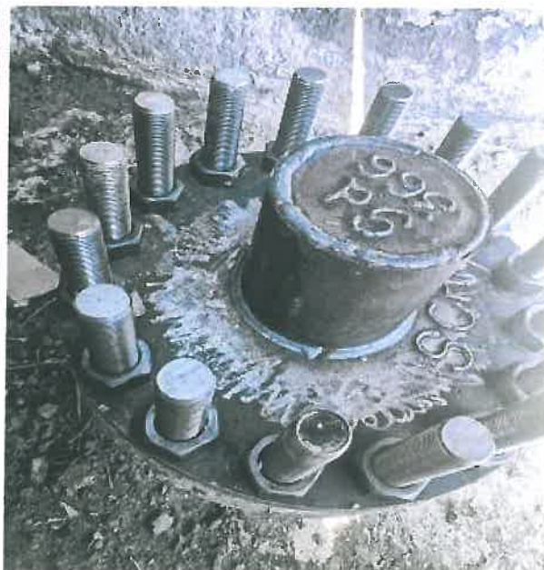
Foto 14: Sonda 366 MP Schela Blinda montata si asigurata in 16 prezoane.
