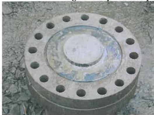
Fig.23,24: Operatia de montare a blindei inscriptionate cu numarul sondei
