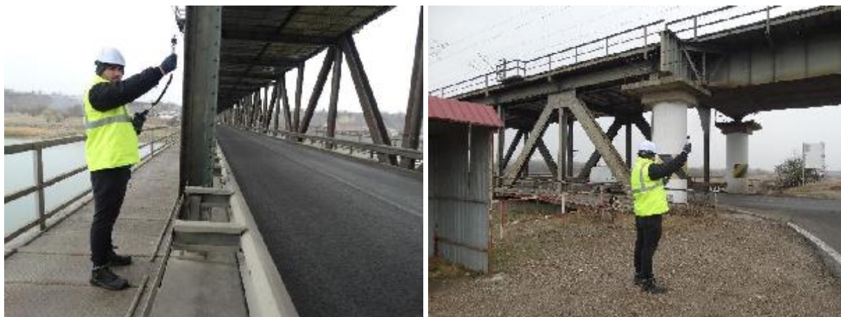
Foto 6.3. Prelevare și măsurare probe de aer – emisii: pulberi în suspensie (PM 10 )
