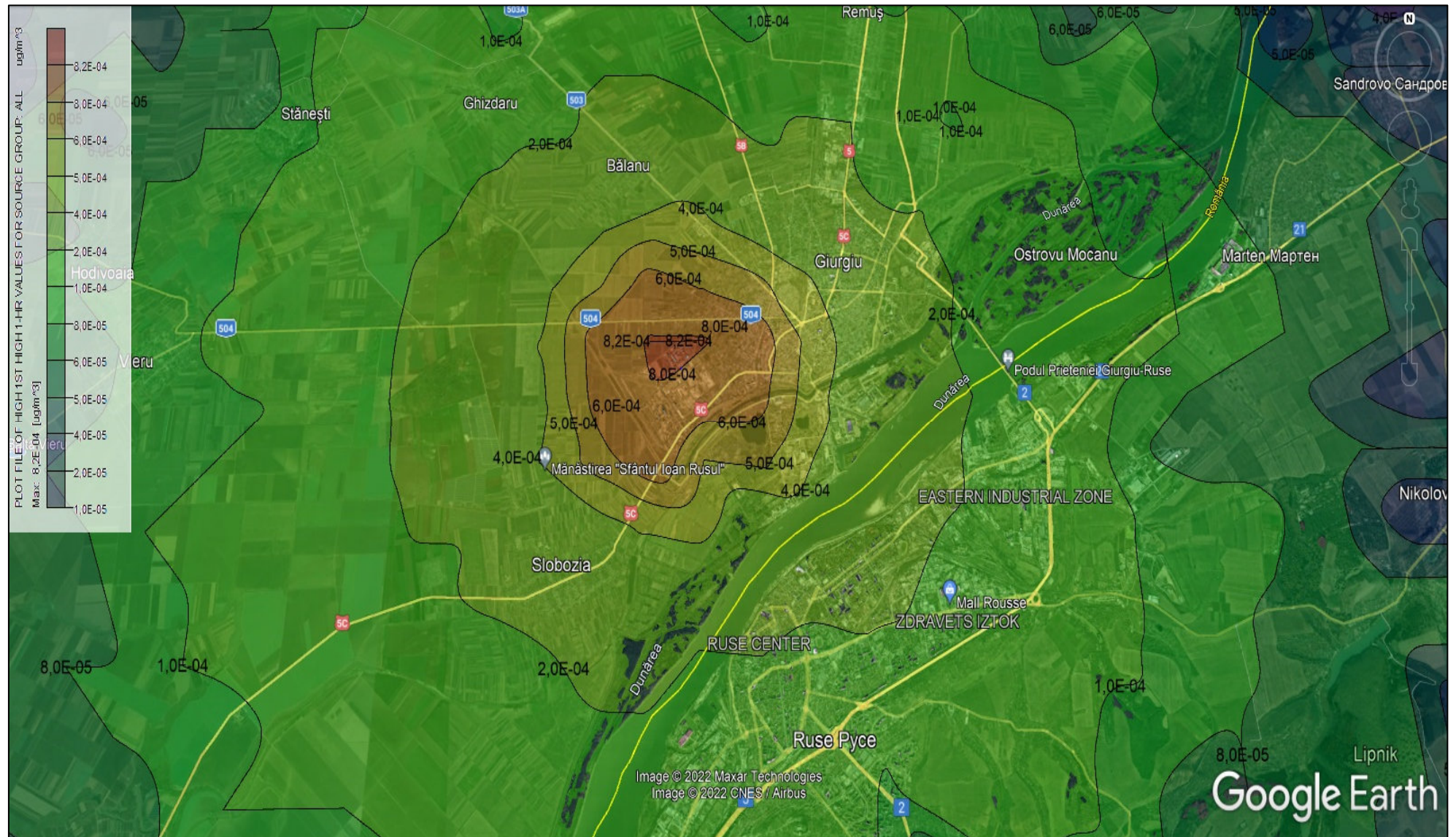
Figură 78 - Modelare a dispersiei concentrației în imise de dioxine și furani – perioadă de mediere 1 h (detaliu)
