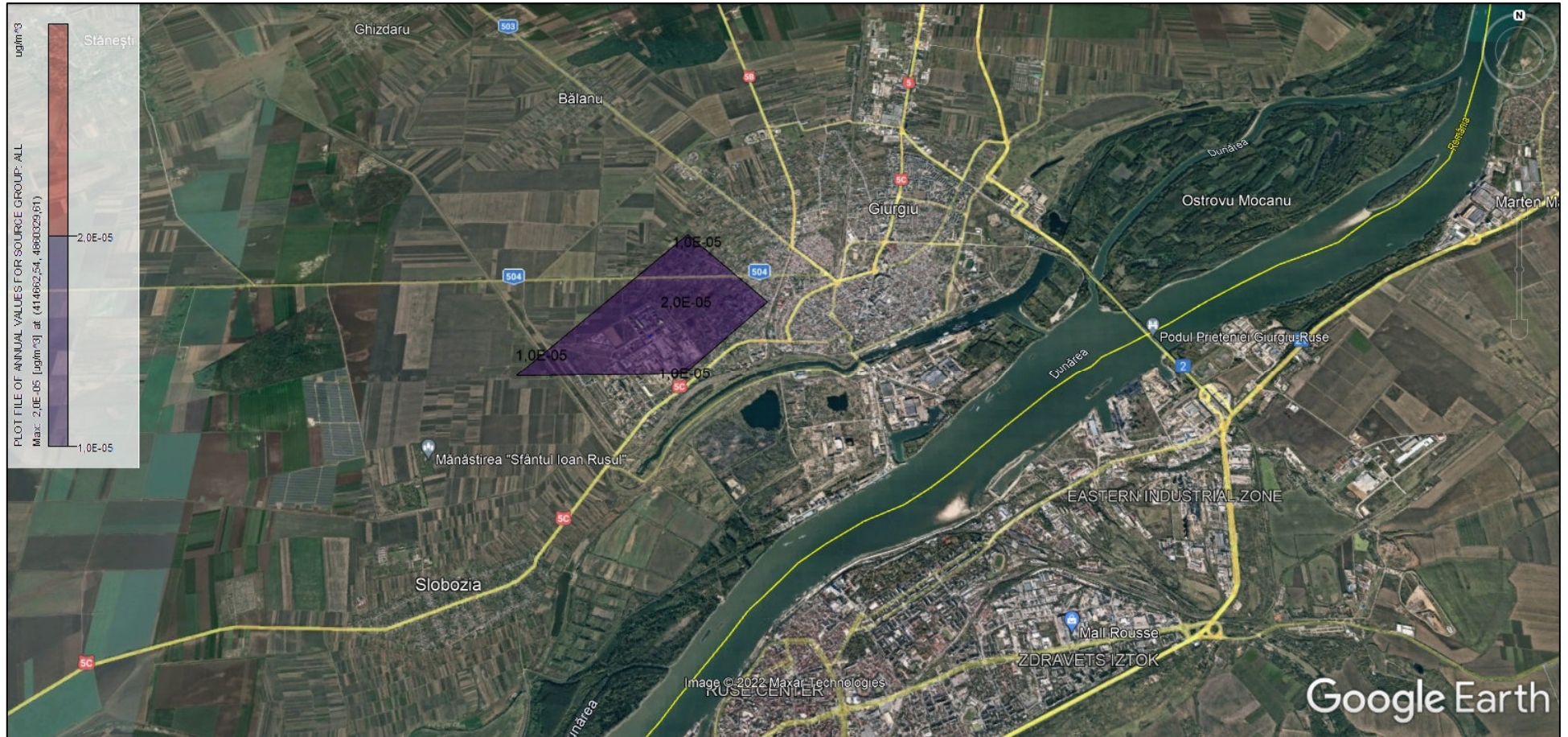
Figură 83 - Modelare a dispersiei concentrației în imise de dioxine și furani – perioadă de mediere 1 an
