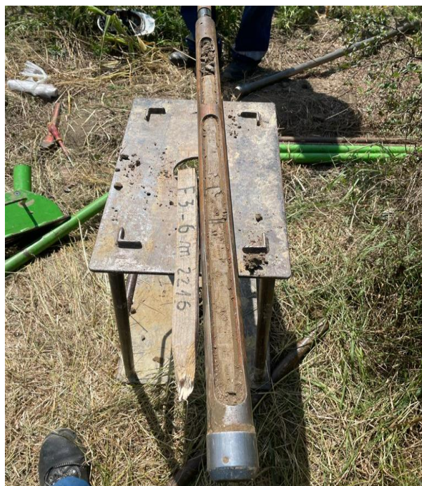
Poze realizate pe amplasament cu ocazia prelevării probelor de sol pentru studiul geotehnic
