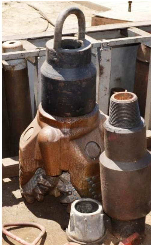
Figura nr. 2-2 Model de sapa cu role, utilizată în procesul tehnologic de foraj, amplasată pe una din localțiile AMROMCO ENERGY SRL
