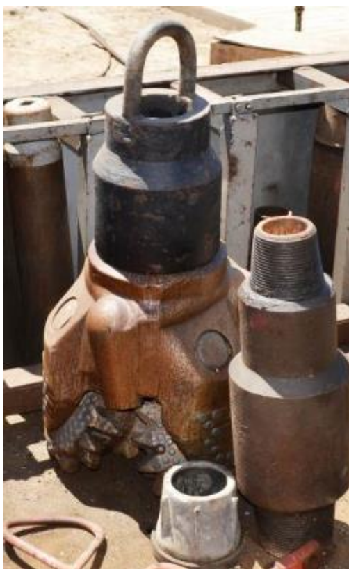
Figura nr. 2-1 Model de sapă cu role, utilizată în procesul tehnologic de foraj, amplasată pe una din localțiile Amromco Energy SRL
