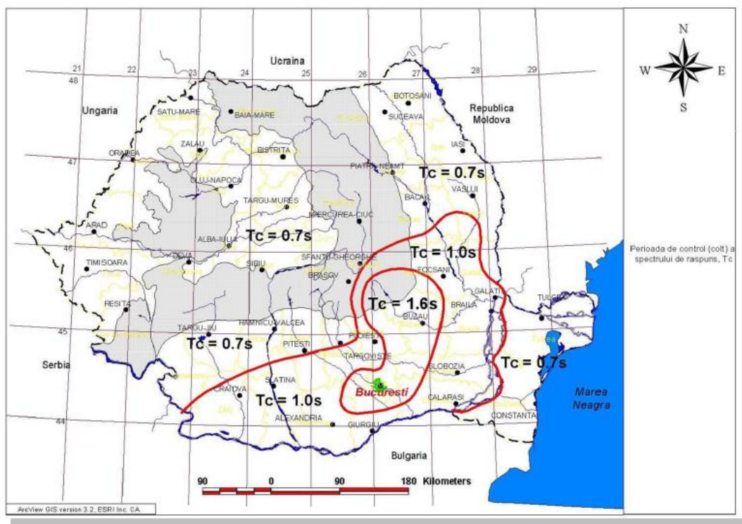
Figura 15 - Zonarea teritoriului Romaniei în termeni de perioada de control (colt), T_c , a spectrului de răspuns
