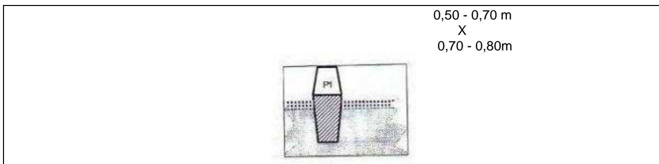
Fig. 3. Model de borna inscriptionata pentru materializarea in teren a profilelor etalon pentru masuratori topo ante si post executie
