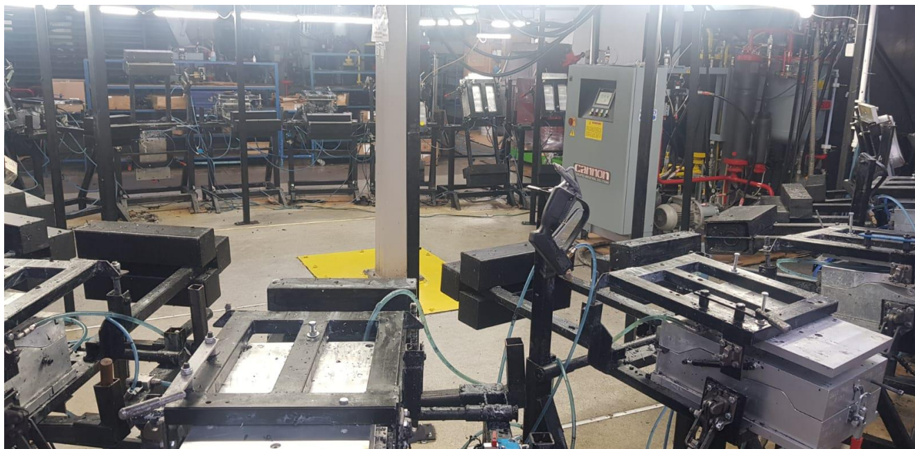
Figura 1. Linie fixa pentru turnare componente poliuretanic
