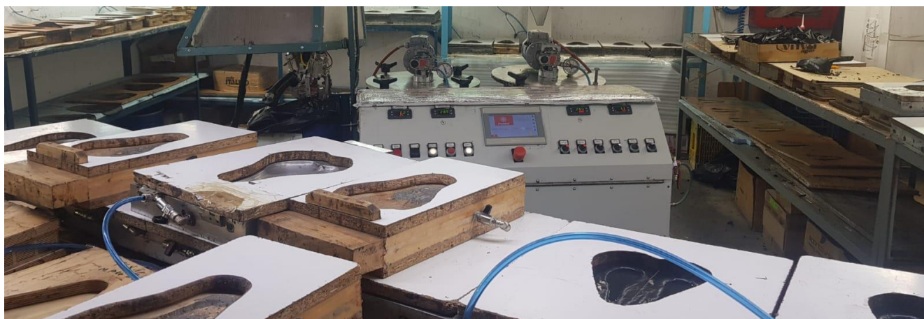
Figura 2. Linie mobilă pentru turnare componente poliuretanic
