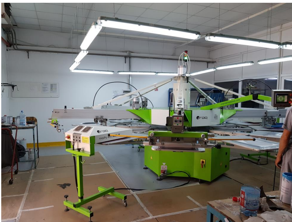
Figura 16. Mașina de serigrafie cu 12 posturi pentru inscripționări pe piele
