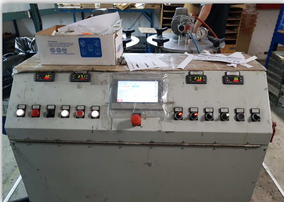
Figura 8. Computer dozare / urmărire materii prime Linie mobilă turnare componente (scaune pentru bicicleta) FABRI S.R.L.
