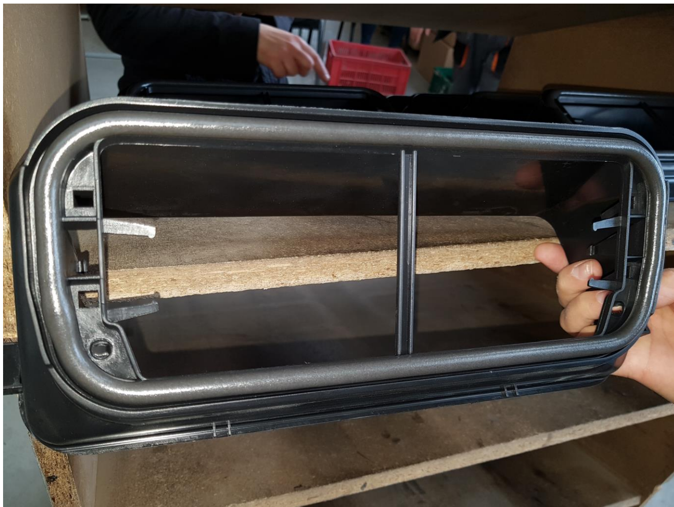
Fig.4.3 Componente auto cu strat de spuma poliuretanică aplicat pe material plastic
