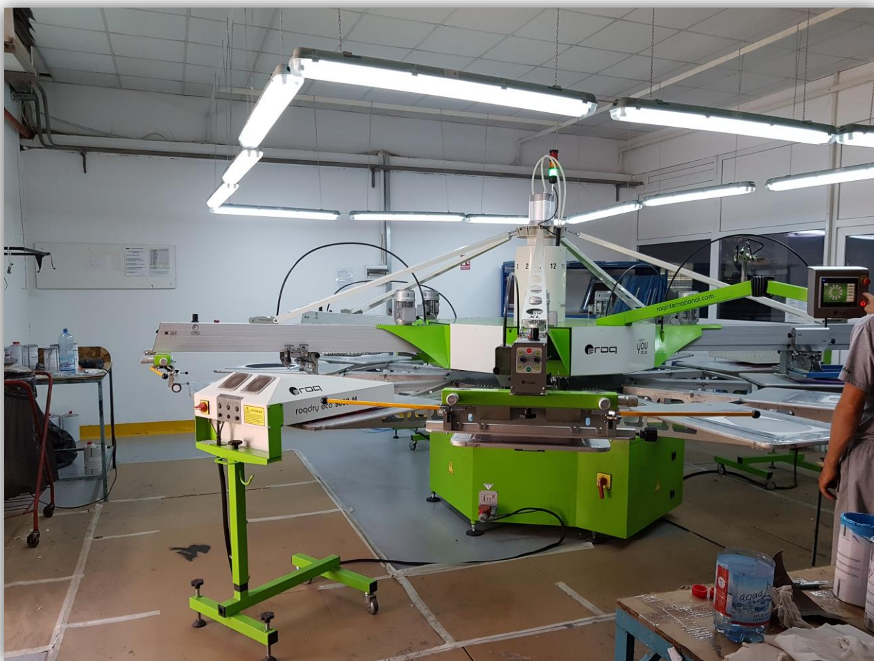
Fig. 2.3.8. – Mașina de serigrafie cu 12 posturi pentru inscripționări pe piele
